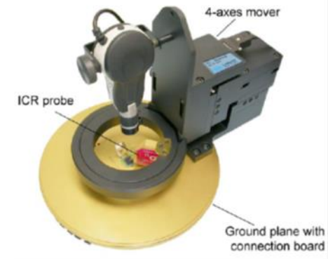
Оборудование, реализующее метод поверхностного сканирования (согласно стандарту МЭК 61967-3)
